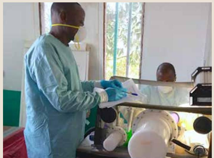
Zwei Mitarbeiter des LFHVG inaktivieren Proben in einer Unterdruck-Glovebox.
